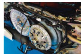
大型バイク等にも採用される、音が静かで変速がスムーズな“自動二輪車用変速ベルト”
