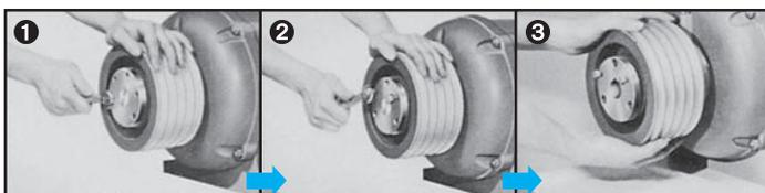
1 Die Befestigungsbolzen entfernen
