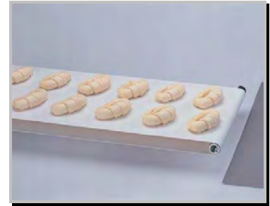
食品搬送用 『ママライン』パン搬送に使われる樹脂ベルト
